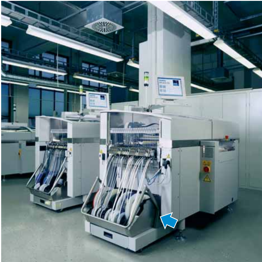
BILD 4 Pick-and-Place Automat, bei dem der Wagen mit der Bauteilespule über ODU MAC angedockt wird.
