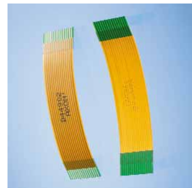
▲ POLYIMIDE INSULATION : UPPER TAPE OPAQUE/ LOWER TAPE CLEAR ; INK-JET MARKING
