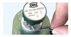
Um den Positionierer in dieser Stellung zu sichern, muss nun noch die Sicherungsnadel angebracht werden. Bei der "038er-Zange" werden hier Inbusschrauben statt eines Sicherungsstiftes verwendet.
