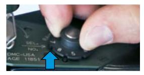
Das Einstellrad muss hier auf die angegebene Kennzahl gedreht werden. Ist das Maß eingestellt, muss das Einstellrad nun noch mit einer Sicherungsnadel fixiert werden.
