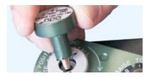
Der Positionierer wird unter Beachtung der Führungen in die Zange geschoben.
