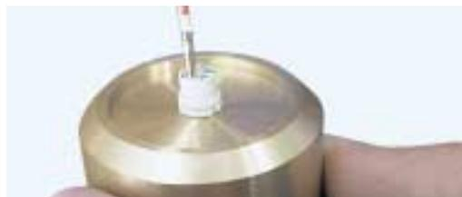
Kontakte unter Berücksichtigung der Polnummerierung in den Isolierkörper schieben. Bei losen Isolierkörpern dabei einen Haltering verwenden.
