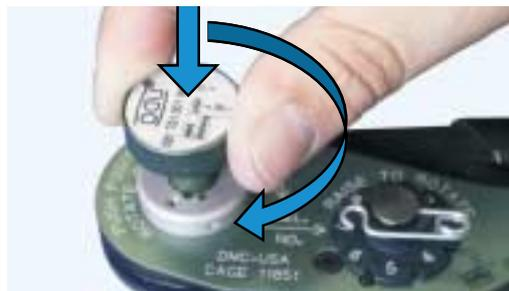
037: Dabei wird der Positionierer nach unten gedrückt und zeitgleich nach rechts gedreht.
