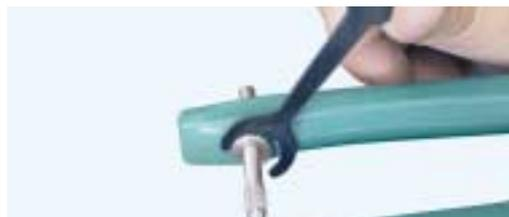
Als erstes muss die Befestigungsmutter der Stellschraube mit dem Schlüssel etwas gelöst werden.
