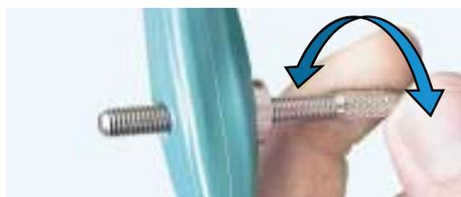
Nun können durch drehen an der Stellschraube die Pressbacken in der Zange verstellt werden. Die Zange muss dabei auf Anschlag zusammengedrückt werden. Mit der Stellschraube kann der benötigte Anschlussquerschnitt eingestellt werden.
