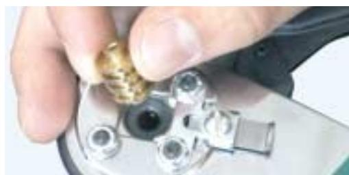
Positionierer wird in die Zange eingelegt.
