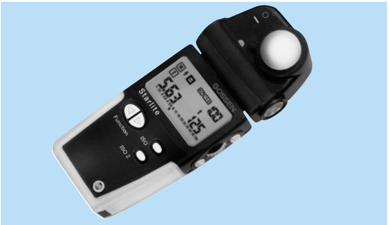
Belichtungsmesser – geräteinterne Verbindung zwischen Grundgerät und flexiblem Messkopf mit MINI-FLAKAFIX
