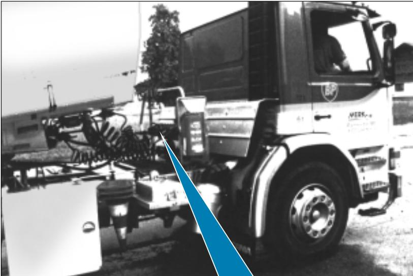
Wasserdichter Steckverbinder (IP 65),
