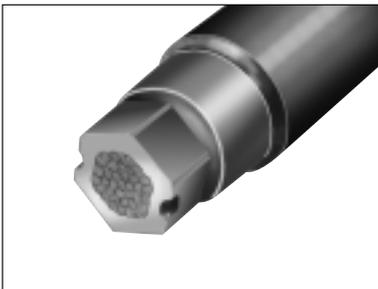
Querschnitt einer 6-Kantquetschung.
