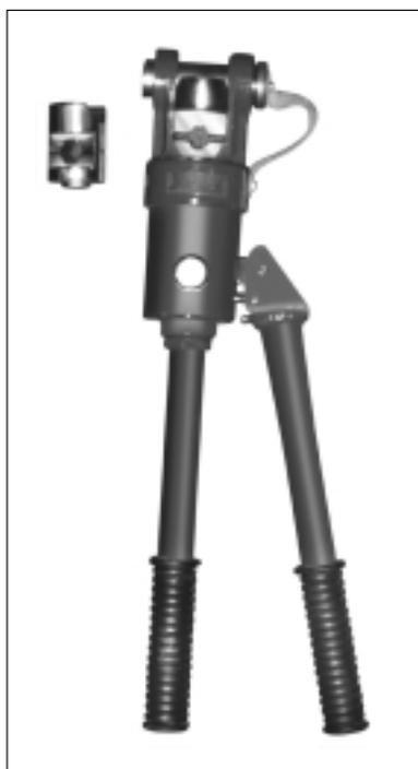
**Hydraulische Quetschzange** für Querschnitte 16 mm<sup>2</sup> bis 120 mm<sup>2</sup> mit Sicherheitsventil, welches sich automatisch öffnet wenn der zum vollkommenen Verpressen nötige Druck erreicht wird.
