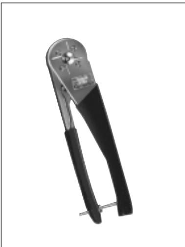
**8-Punktquetschzange** für Querschnitte AWG 22 – 1,5 mm<sup>2</sup> verstellbar. Zum Verstellen (2) Paßstift (1) verwenden! (Siehe Einstellmaßtabelle). Kontakthalter = Positionierer (3) zum leichteren Positionieren der Quetschlage auf Anfrage. 8-Punktquetschzange mit Pneumatikbetätigung (Halbautomat) auf Anfrage.
