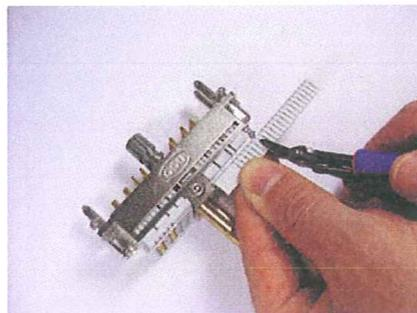
und die Sekundärverriegelung mit Hilfe der vorhandenen Rasterung (2,4 mm) auf die benötigte Länge zuschneiden.
