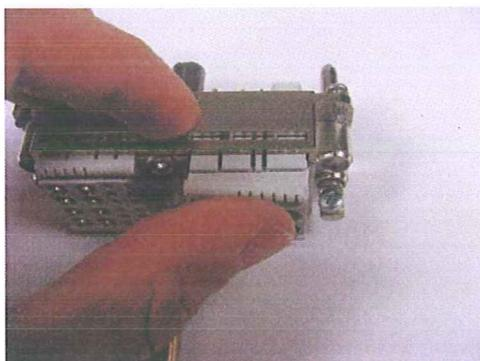
Anschließend die Sekundärverriegelungen in die Rasthaken der Module einklicken
