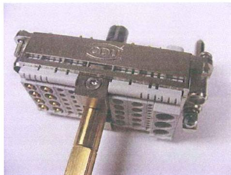
Die korrekt montierten Sekundärverriegelungen stellen sicher, dass alle Module im Rahmen korrekt eingerastet sind
