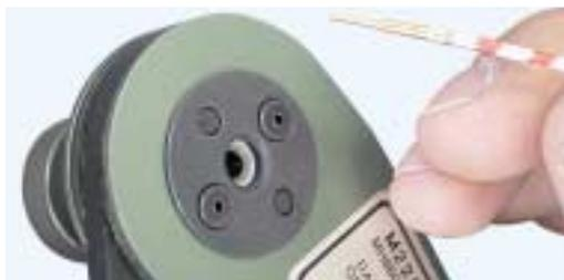
Zange auf Anschlag zusammendrücken. Fertig gecrimpten Kontakt entnehmen.
