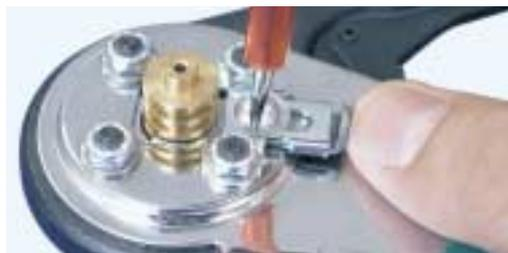
Hier wird nun der Positionierer mittels eines Schiebers in der Zange fixiert. Dieser Schieber muss nun mit einem Schraubendreher festgestellt werden.
