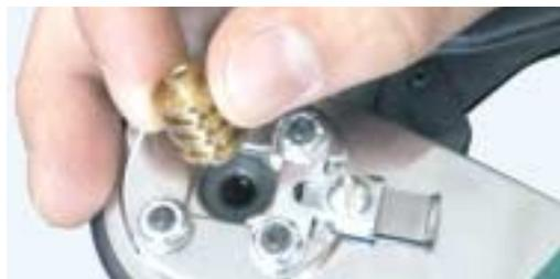
Positionierer wird in die Zange eingelegt.
