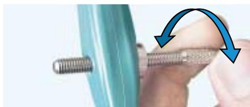
Nun können durch drehen an der Stellschraube die Pressbacken in der Zange verstellt werden.
