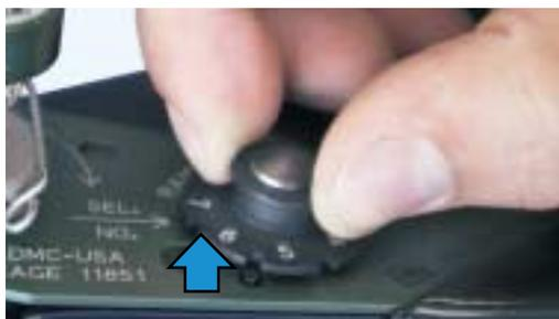
Das Einstellrad muss hier auf die angegebene Kennzahl gedreht werden. Ist das Maß eingestellt, muss das Einstellrad nun noch mit einer Sicherungsnadel fixiert werden.
