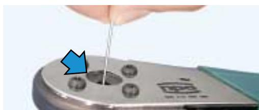
Mit den Einstelldornen muss der Anschlussquerschnitt überprüft werden. Dabei muss über die Stellschraube solange nachjustiert werden, bis der kleinere Einstelldorn durch die Pressbacken gerade noch durchgesteckt werden kann, der größere jedoch nicht mehr. Ist dies der Fall, so kann mit dem Crimpvorgang begonnen werden.
