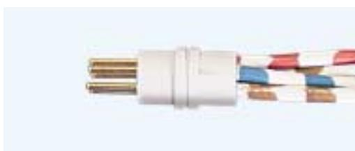
So sieht nun der fertig konfektionierte Einsatz aus, welcher nun in den Stecker montiert werden kann.
