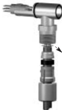
8. Spannschraube (2) auf den montierten Stecker schrauben und mit ODU-Gabelschlüssel anziehen. Gewinde ggf. mit Sicherungskleber benetzen.
