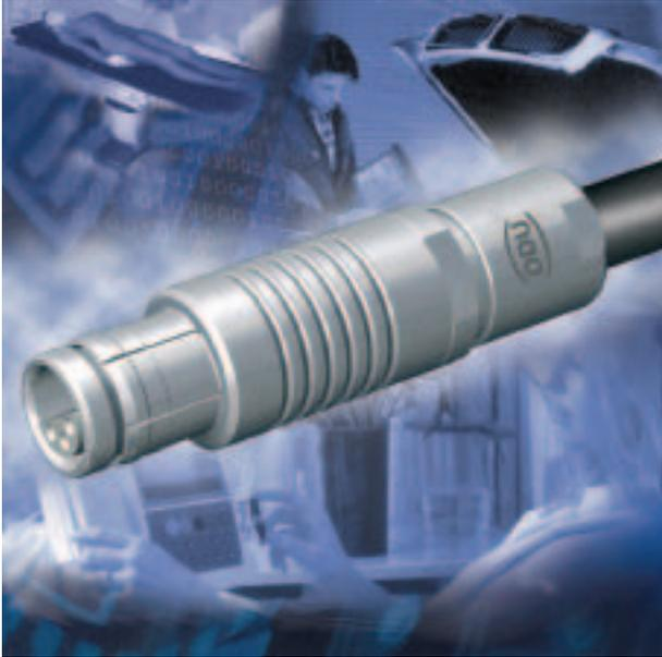
Rundsteckverbinder aus Metall mit Push-Pull Verriegelung - FP Verriegelungsprinzip über Kegelhülse, Kodierung über Isolierkörper.
