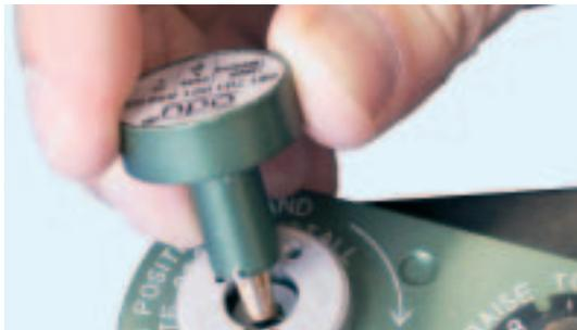
Der Positionierer wird unter Beachtung der Führungen in die Zange geschoben.
