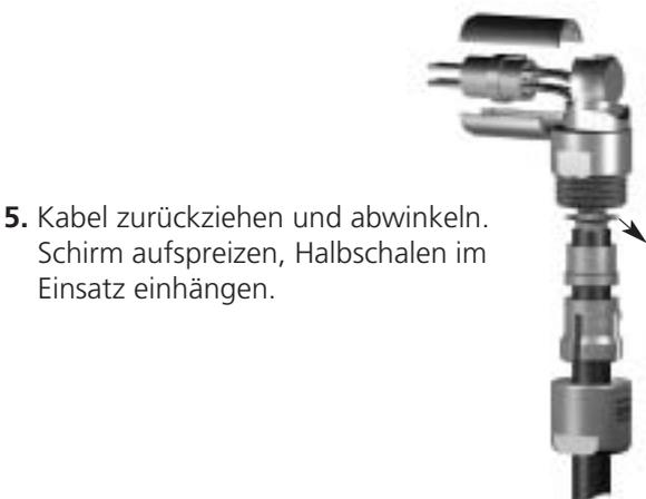
**5.** Kabel zurückziehen und abwinkeln. Schirm aufspreizen, Halbschalen im Einsatz einhängen.
