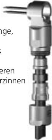
6. Schirmring, Dichtring und Spannzange gegen das Winkelteil schieben, so dass der Schirm zwischen Schirmring und Winkelteil eingeklemmt wird. Spannmutter (1) montieren, an Fläche (A) mit Gabelschlüssel gehalten, Halbschale im Einsatz einhängen. Gewinde ggf. mit Sicherungskleber benetzen.
