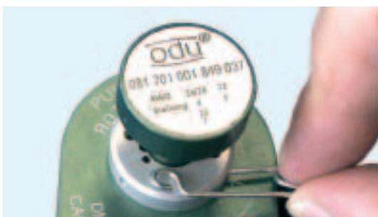
Um den Positionierer in dieser Stellung zu sichern, muss nun noch die Sicherungsnadel angebracht werden. Bei der „038er-Zange“ werden hier Imbusschrauben statt eines Sicherungsstiftes verwendet.
