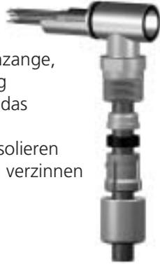
6. Schirmring, Dichtring und Spannzange gegen das Winkelteil schieben, so dass der Schirm zwischen Schirmring und Winkelteil eingeklemmt wird. Spannmutter (1) montieren, an Fläche (A) mit Gabelschlüssel gegenhalten, Halbschale im Einsatz einhängen. Gewinde ggf. mit Sicherungskleber benetzen.
