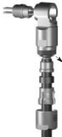
8. Spannschraube (2) auf den montierten Stecker schrauben und mit ODU-Gabelschlüssel anziehen. Gewinde ggf. mit Sicherungskleber benetzen.
