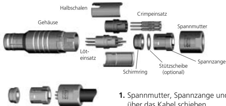
1. Spannmutter, Spannzange und Schirmring über das Kabel schieben
