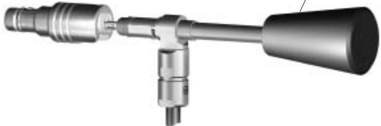
7. Das montierte Kabel mit dem Montagewerkzeug unter Beachtung der Führungen in das Steckergehäuse schieben.
