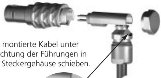
7. Das montierte Kabel unter Beachtung der Führungen in das Steckergehäuse schieben.
