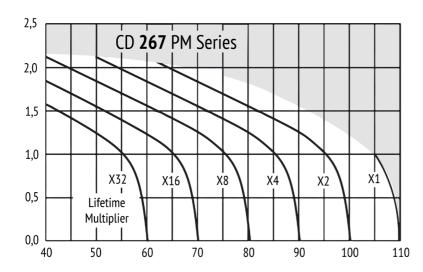
x-axis:  $T_A$  (°C) y-axis:  $\frac{I_A}{I_R}$
