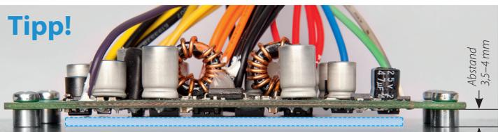
Bei Temperatur-Anbindung der Platine zum Gehäuseboden über ein **Wärmeleitkissen (Gap Pad®)** verringert sich die Temperatur der Platine je nach Umgebungstemperatur um ca. 10...20 °C.
